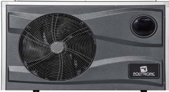
Die neuen Wärmepumpen der Serenity Serie verfügen über Titanwärmetauscher mit speziell gewellten Titanrohren um eine größere Oberfläche zu erhalten und dadurch eine bessere Wärmeübertragung zu erreichen. Der Verdampfer ist mit einer Blue Fin Beschichtung ausgestattet, dadurch kann das Kondensationswasser besser und schneller ablaufen und auch dies steigert die Effizienz.
