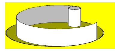
Achtung: Der vorgestanzte Skimmerausschnitt befindet sich ca. 200 cm vom äußeren Wandende entfernt. Achten Sie darauf, daß beim Einsetzen der Stahlwand sich der Skimmerausschnitt auch am gewünschten, richtigen Ort befindet. Bei Schwimmbecken mit 2 Stahlwänden befindet sich der Skimmerausschnitt in der Wand 1.
