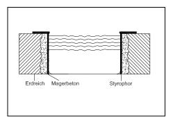
Wir empfehlen den Beckenrand etwa 10 cm herausragen zu lassen, um so einen Schutz vor Verschmutzung durch Kleintiere, Staub, Laub, usw. zu haben.
