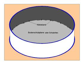
Boden nochmals gründlich reinigen, Schutzvlies auslegen, einzelne Bahnen Stoss an Stoss legen und mit Klebeband fixieren.. Schneiden Sie die Bodenschutzplane oder das – vlies ca. 5 – 10 cm größer als die Beckenform zu und kleben Sie den entstehenden Überstand an der Stahlwand fest. (Ränder über die Bodenschienen ziehen. Verwenden Sie hierzu PVC-verträgliches Klebeband (z.B. Paketband). Bodenschutzplane oder –vlies glatt ziehen.
