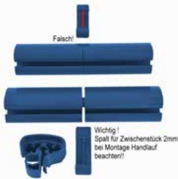
Innenhüllenfallen in der Seitenwand durch seitliches Verschieben der Innenhülle korrigieren. Bei gutem Sitz Handlauf durch Schläge mit der flachen Hand oder mit einem Gummihammer komplett aufdrücken. **Achtung: unbedingt kontrollieren ob das Becken absolut in der Waagrechten steht.**
