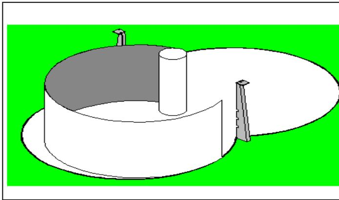
**Ein wichtiger Tip:** Damit die Stahlwand provisorisch gehalten wird, legen Sie einige Handlaufprofilschienen auf den oberen Stahlwandrand.
